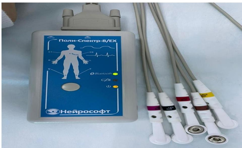
Рисунок 13 – Аппарат для определения вариабельности сердечного ритма «Поли-СПЕКТР» фирмы «Нейрософт»
